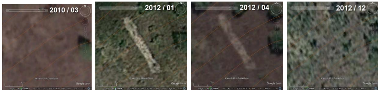
Figura 4-4. Pequeño deslizamiento (4x25 m) superficial que se produjo en algún momento entre marzo de 2010 y enero de 2012, y volvió a vegetarse completamente en diciembre de 2012.
