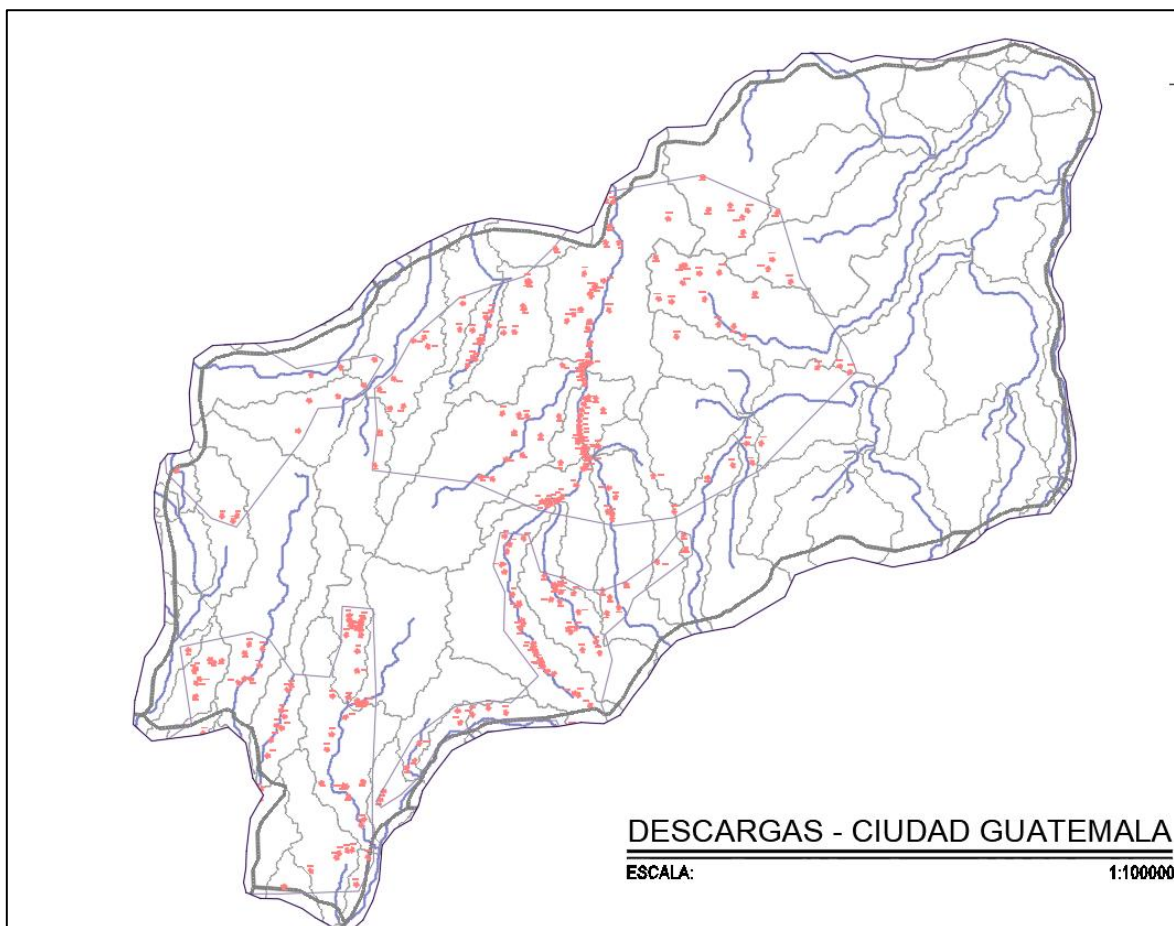
Ilustración 90 Descargas de Drenaje Ciudad de Guatemala
