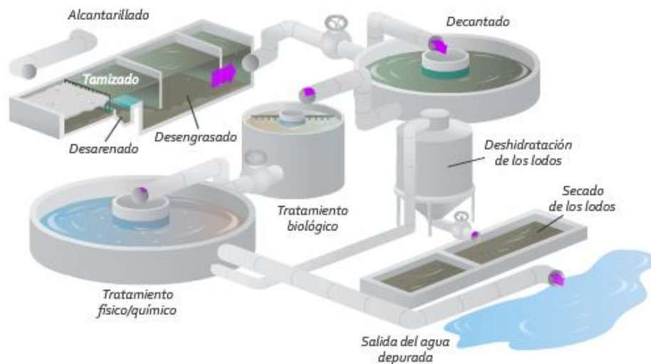
Figura 5. Planta de tratamiento de aguas residuales
